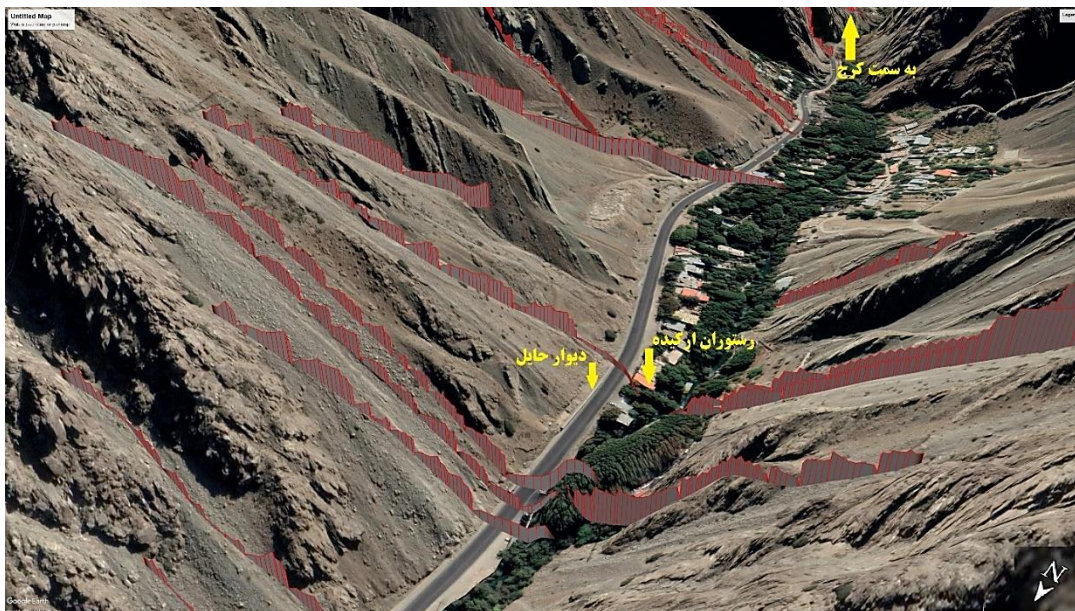
شکل ۸: نمای سه بعدی از وضعیت سنگ ریزش جاده چالوس در محدوده رستوران ارکیده. خطوط قرمز لغزشی، پرواز و سقوط سنگ را نمایش داده‌اند. برگرفته از گوگل ارث (نگاه به سمت جنوب غرب).
