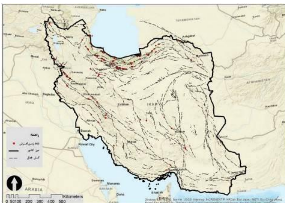
شکل ۳۴: زمین لغزش های واقع در حریم ۵۰۰ متری گسل های فعال
