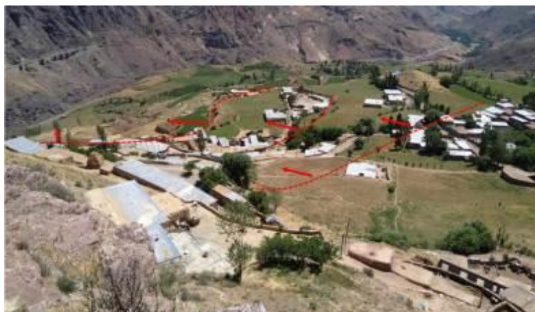
شکل ۲۰: آثار حرکت زمین لغزش در بافت روستا و بخصوص در منطقه ۸ در شکل ۱۱، از آنجا که زمین لغزش کفچرین رفتار پسرونده داشته، شدت گسیختگی و جابجایی در پنجه بیشتر بوده و هر چه به سمت بالادست و اسکارپ اصلی لغزش کمتر می شود. در ضمن عمق لغزش نیز کاهش می یابد.
