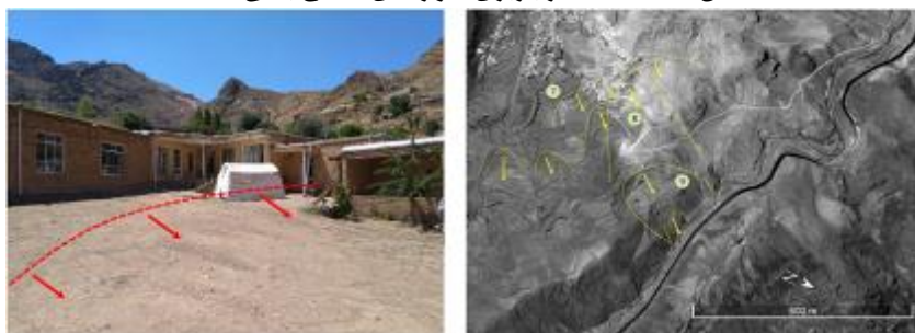
شکل ۱۹: آثار حرکت زمین لغزش در منطقه ۷ در شکل ۱۱، شکل سمت راست آثار پرتگاههای لغزش قدیمی را نشان می دهد. شکل سمت چپ مربوط به موقعیت ۷ است. همگرایی بردارهای لغزش جدید و قدیم حاکی از فعالیت مجدد زمین لغزش بزرگ است.
