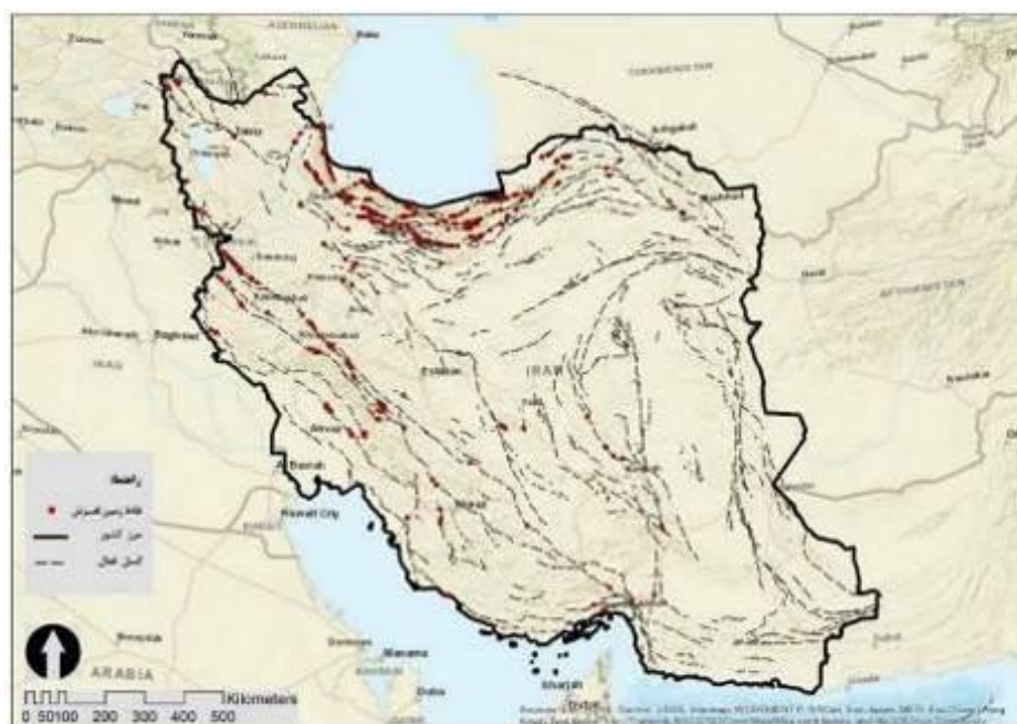
شکل ۳۵: زمین لغزش های واقع در حریم ۲۰۰۰ متری گسل های فعال
