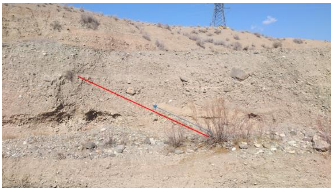
شکل شماره ۸: نمایی از گسل کوندج در جنوب روستای بهجت آباد در مختصات 50/22/4.6 , 36/08/34 (دید به سمت غرب). در این محل گسل کوندج لایه رسی و لایه شنی را جابجا نموده است.
