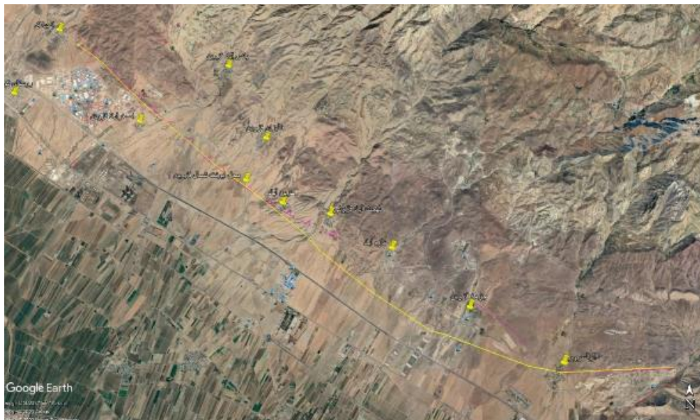
شکل شماره ۲۰: نمایی از موقعیت جدید و تدقیق شده گسل کوندج براساس یافته های پژوهش (رنگ زرد) و موقعیت اقتباس شده گسل کوندج از نقشه زمین شناسی ۱:۱۰۰.۰۰۰ قزوین بر روی تصویر Google Earth (رنگ بنفش). با توجه به مشاهدات صحرائی و شواهد بدست آمده، موقعیت گسل در آبرفت های کوتاه تر بطول حدود ۱۱ کیلومتر در جنوب روستاهای بهجت آباد، تازه آباد و جزمه نسبت به موقعیت آن در نقشه زمین شناسی اصلاح گردید.
