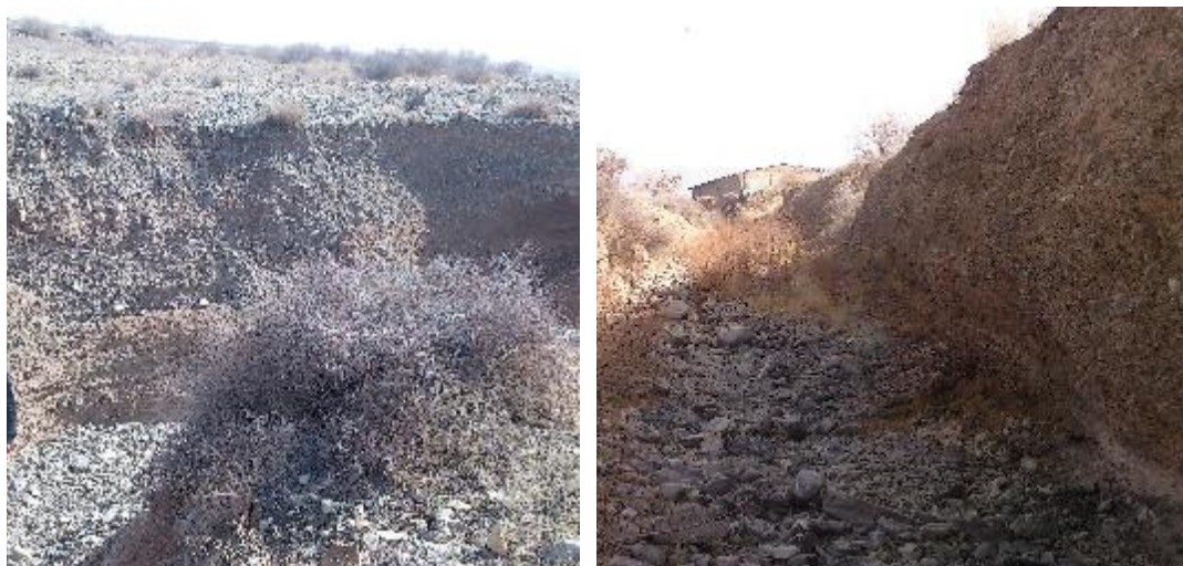
شکل شماره ۱۴: نمایی از ترانشه ابراهه روستای فالیزان، در نزدیکی روستا در مختصات 50/21/0.93 , 36/10/9.93 (سمت راست) که دارای نهشته های مخروط افکنه ای (Qf2) و ته نشست های سخت نشده قلوه دار است و در جنوب روستا در مختصات 36/09/42.43 , 50/20/38.47 (سمت چپ) که دارای نهشته های سخت نشده قلوه دار و ریزدانه بوده و دارای عمق بیشتری است.
