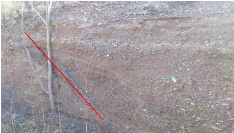
شکل شماره ۱۲: نمایی از گسل کوندج در جنوب روستای جزمه در مختصات 36/06/35.4 , 50/25/4.1 (دید به سمت غرب). در این محل گسل کوندج لایه واجد دانه های ریزدانه را جابجا نموده است.
