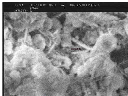
شکل ۴. تصویر SEM کانی باسانیت در رسوبات دریاچه مهارلو
