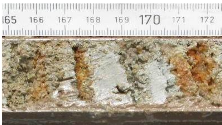
شکل ۸. بلورهای مکعبی هالیت درون رسوبات مغزه HSI در اعماق ۱۶۵-۱۷۲ سانتی‌متری
