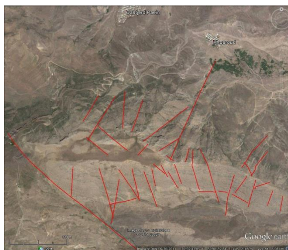
شکل ۱۴. نمونه‌ای از خطواره‌ها (گسل‌ها و آبردرزه‌ها) در منطقه خسرو در سازند کربناته الیکا
