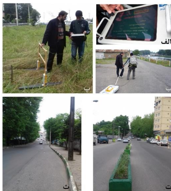
شکل ۹. الف) نمایشگر XV دستگاه رادار نفوذی زمین، ب) آنتن ۲۵۰ مگاهرتز پوششی، پ) آنتن ۱۰۰ مگاهرتز غیر پوششی، ت) تغییر ارتفاع ناگهانی در سطح زمین در خیابان گیلستان، جهت دید به سمت جنوب، ث) همان خیابان جهت دید به سمت شمال
