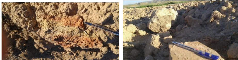
شکل ۱۱. رسوبات آبرفتی کف دره، مخلوط سیلت و رس تا ریگ و قلوه‌سنگ و رسوبات آهن‌دار بین نهشته‌های رسوبی
