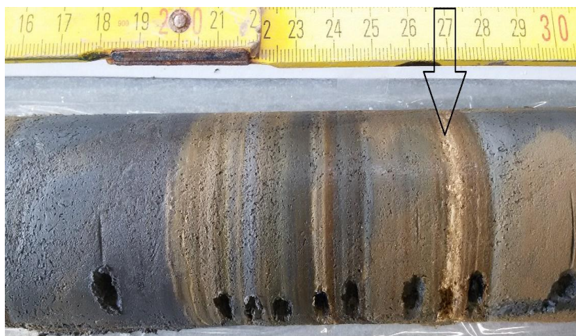
شکل ۸. تناوب لایه‌های رسوبی در مغزه سردریا. لایه مورد نظر با حداکثر مقدار کربن غیر آلی و همچنین حداکثر Ca در مغزه مشخص شده است.
