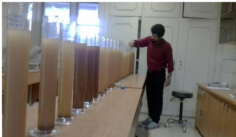
شکل ۵. تعیین بافت رسوبات به روش هیدرومتری
