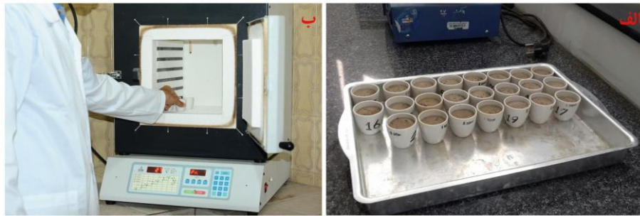
شکل ۶. الف) قرار دادن نمونه‌ها در بوتله‌های چینی؛ ب) گذاشتن بوتله‌های چینی در کوره با دمای ۵۵۰ درجه
