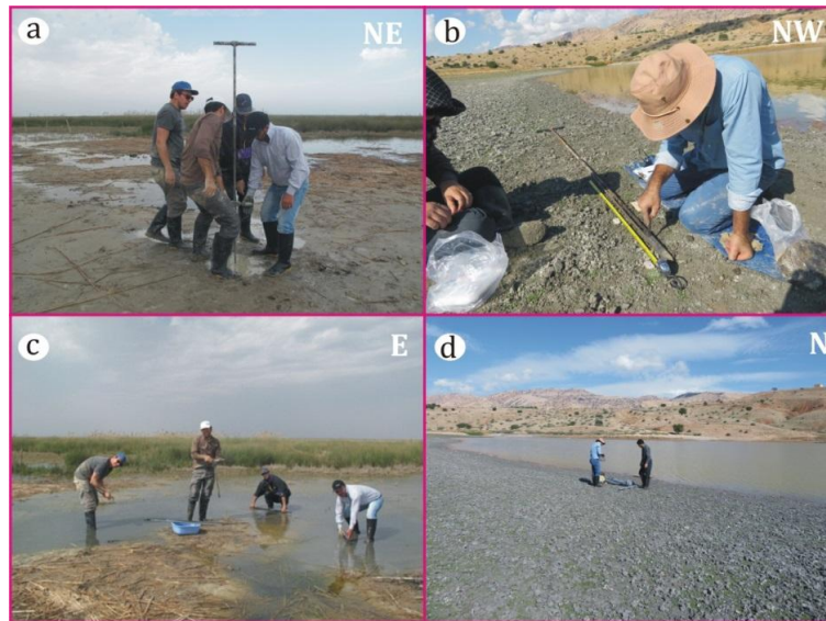
شکل ۴. نحوه مغزه‌گیری: (a) حفاری در رسوبات بستر تالاب آبزالو؛ (b) نمونه‌برداری و توصیف مغزه‌های برداشت‌شده؛ (c) شست‌وشوی وسیله مغزه‌گیری بعد از هر بار مغزه‌گیری جهت جلوگیری از آلودگی رسوبات با رسوبات بخش دیگر؛ (d) نمایی از تالاب آبزالو و زمین‌های اطراف
