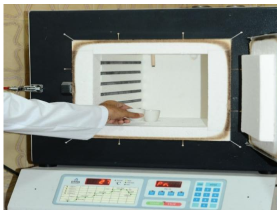
شکل ۵. قرار دادن کروزر محتوی نمونه خاک داخل کوره.
