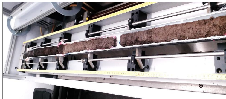
شکل ۶. نحوه قرارگیری نمونه‌ها جهت انجام دادن XRF
