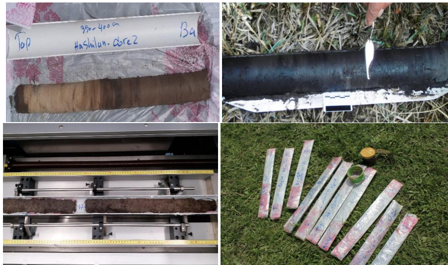
شکل ۳. مراحل برداشت، قرارگیری در لوله‌های پولیکا، بسته‌بندی، و مغناطیس‌سنجی نمونه‌های رسوبی برداشت‌شده
