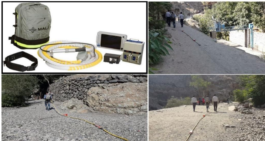
شکل ۱۰. تصاویری از دستگاه GPR مالا آنتن ۵۰ مگاهرتز و برداشت پروفیل‌ها در منطقه مورد مطالعه
