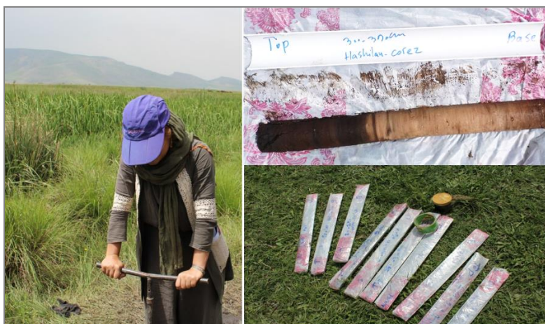
شکل ۲: برداشت مغزه رسوبی، یادداشت کردن مشخصات مغزه برداشت شده، بسته بندی مغزه ها
