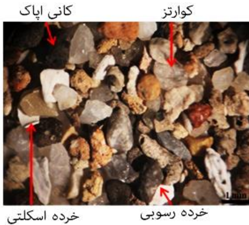
شکل ۴: تصویری از مورفوسکوپی ذرات با میکروسکوپ دو چشمی (از انتهای کانتکتست ۳۱۷ تا انتهای کانتکتست
