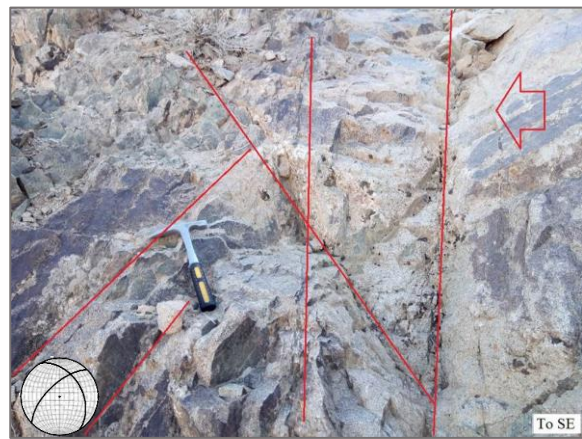
شکل ۴۲: گسل های مزدوج با مشخصات NE 150/41 NW 046/64 در راستای شمال باختری جنوب خاوری و شمال خاوری - جنوب باختری؛ دید به سمت جنوب غرب.
