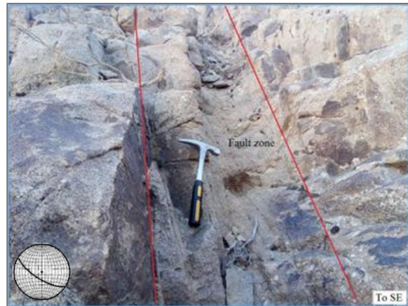
شکل ۴۰: پهله گسلی با روند شمال باختری-جنوب خاوری و ۶۹ درجه شیب به سمت جنوب باختر. (دید به سمت جنوب شرق).
