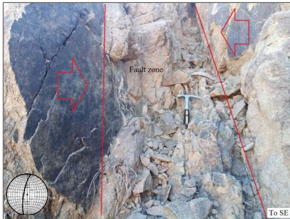
شکل ۴۱: پهله گسلی با موقعیت NW 010/76 که دگرسانی کلریتی در آن مشاهده می شود و ۷۶ درجه شیب به سمت شمال باختر دارد؛ دید به سمت جنوب شرق.
