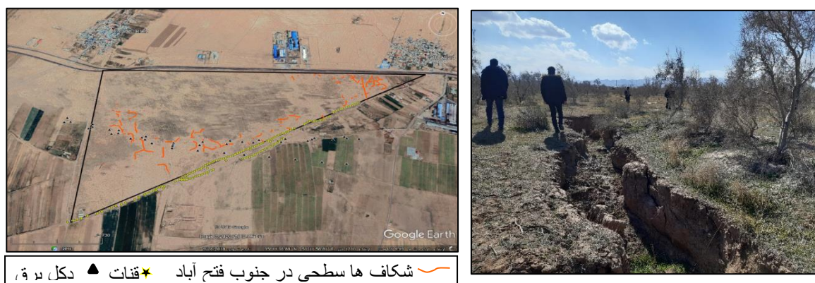
شکل ۱۱: تجمع شکاف‌های سطحی در محدوده جنوب فتح آباد
