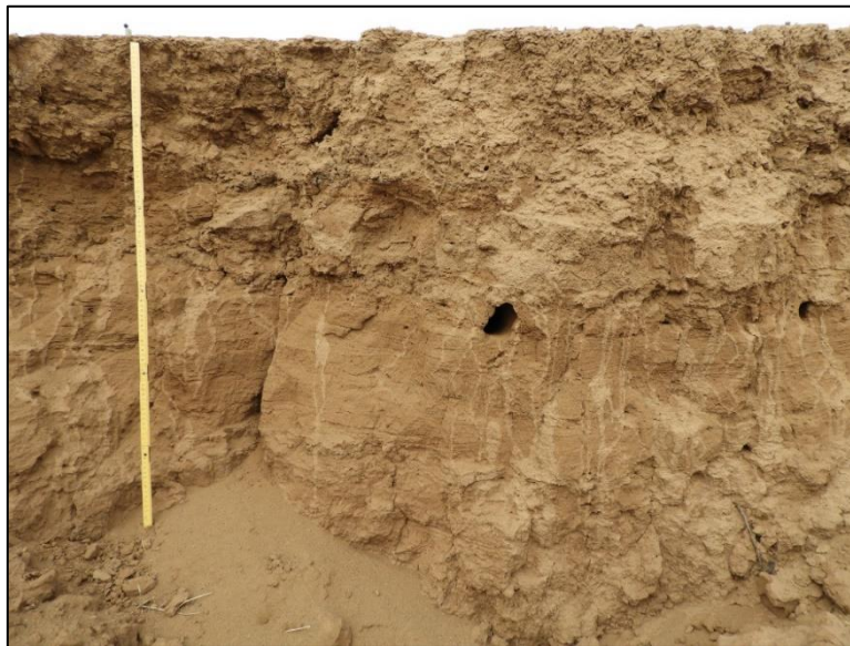
شکل ۱۲: لایه رسی با ضخامت ۳-۴ متر که بر روی ماسه قرار دارد
